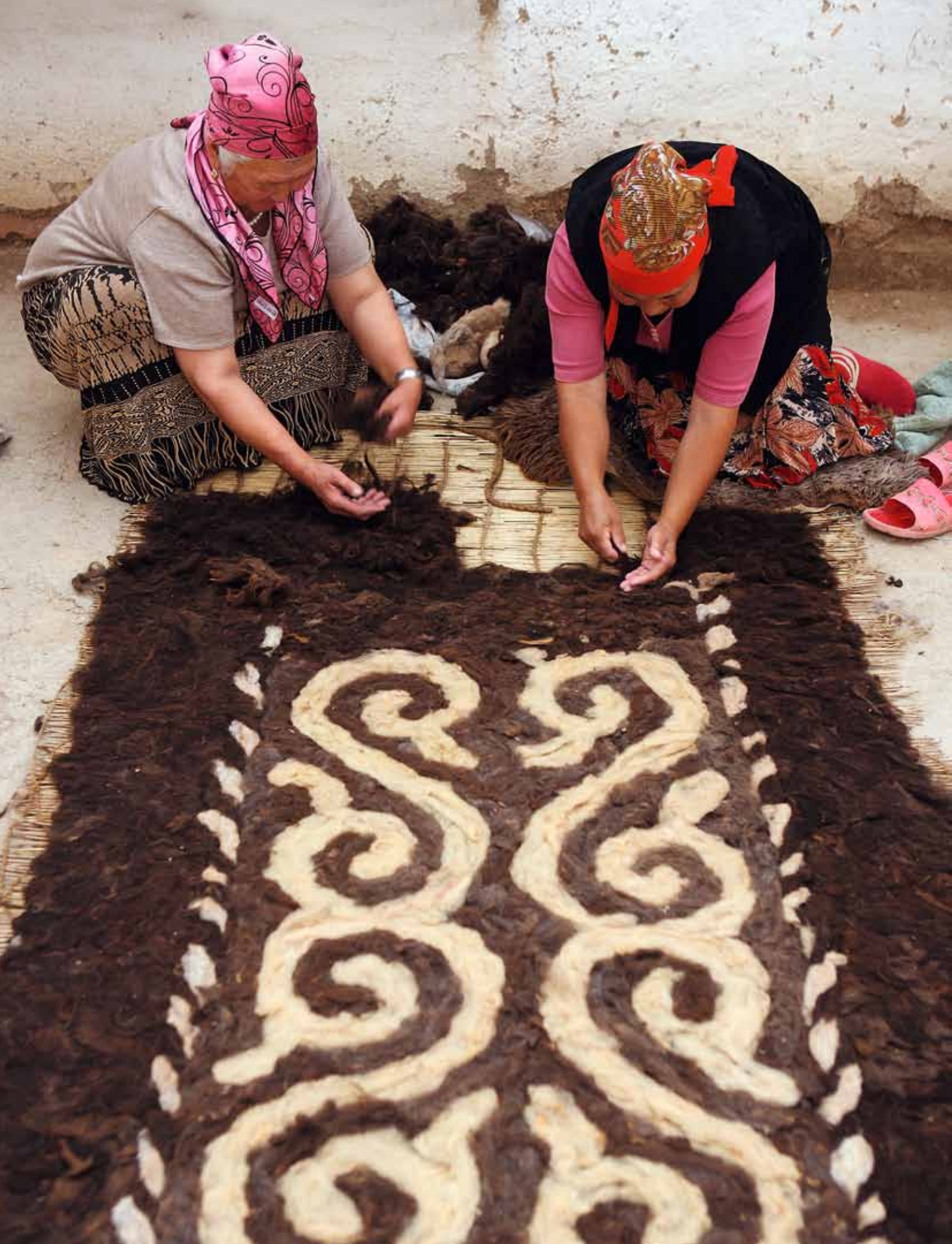
Bei der Nassfilztechnik wird die Wolle auf einer Bastmatte ausgebreitet, mit heissem Wasser durchnässt, zusammengerollt und gepresst. Die beiden Frauen arbeiten an einem Teppich, bei dem das Muster von Anfang an gelegt wird.
